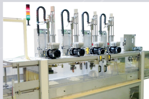
Gekapselter Schleifraum mit obenliegenden Schleifspindeln
